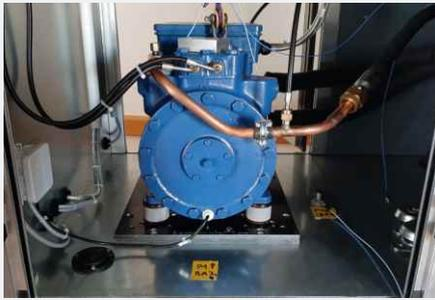
Isolation d'un compresseur à piston avec Isotop MSN-DAMP
