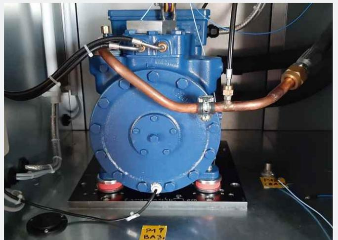
Isolation d'un compresseur à piston avec Isotop Compact
