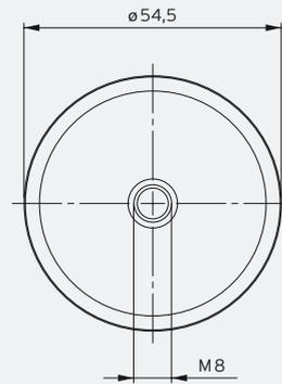
\* Profondeur de vissage pour filetage intérieur max. 7 mm
