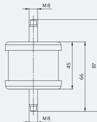
Profondeur de vissage dans le filetage intérieur max. 15 mm environ
