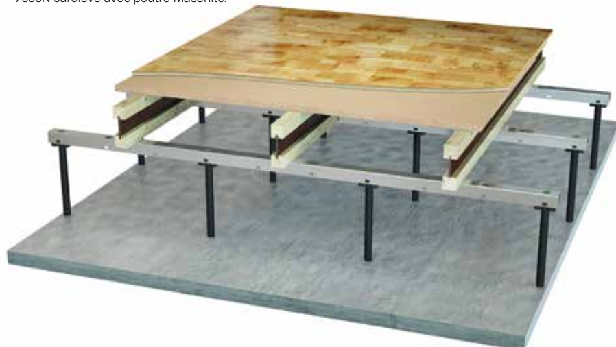
7000N surélevé avec poutre Masonite.
