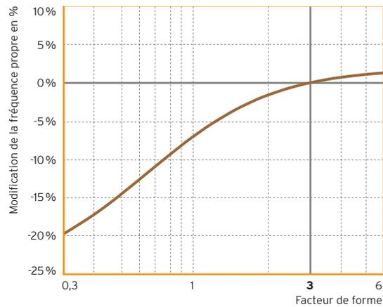
Fig. 8 : Fréquence propre<sup>4</sup> en fonction du facteur de forme
