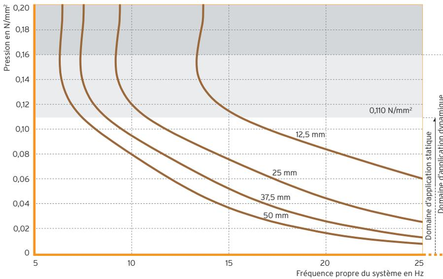
Fig. 3 : Fréquence propre pour différentes épaisseurs d'appui
