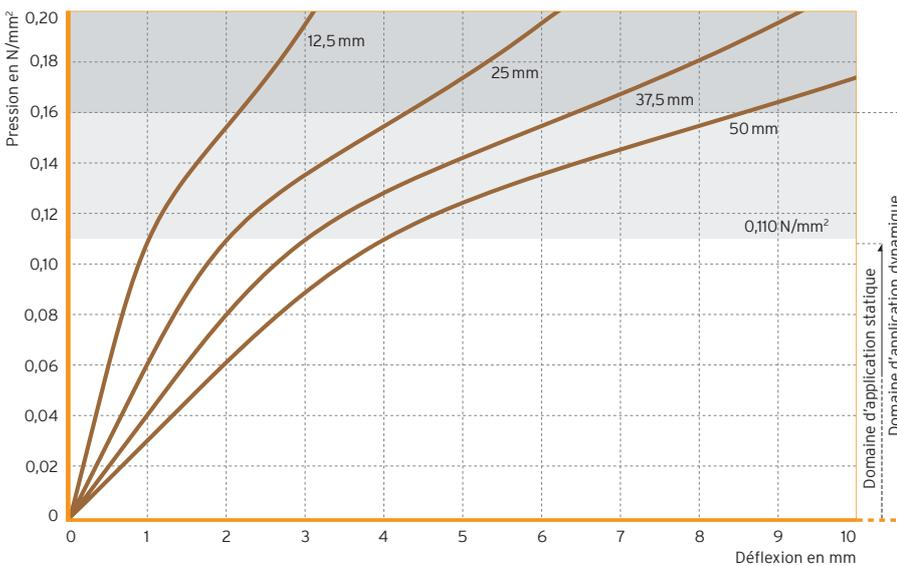
Courbe de déflexion quasi-statique avec une vitesse de charge de 0,011 N/mm<sup>2</sup>/s.
