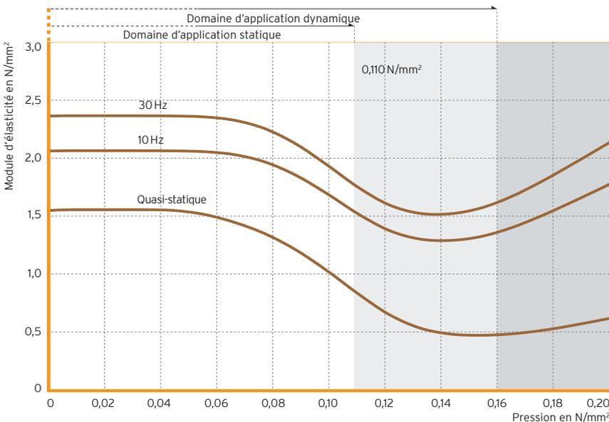
Le module d'élasticité quasi-statique est tangent à la courbe de déflexion. Le module d'élasticité dynamique est soumis à une excitation sinusoïdale à une vitesse vibratoire de 100 dBV Re.  $5 \cdot 10^{-8}$  m/s (en fonction d'une amplitude de vibration de 0,22 mm pour 10 Hz et de 0,08 mm pour 30 Hz).
