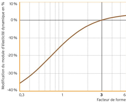
Fig. 7 : Module d'élasticité dynamique<sup>4</sup> pour 10 Hz en fonction du facteur de forme
