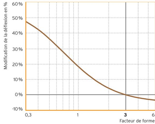
Fig. 6 : Déflexion<sup>4</sup> en fonction du facteur de forme
