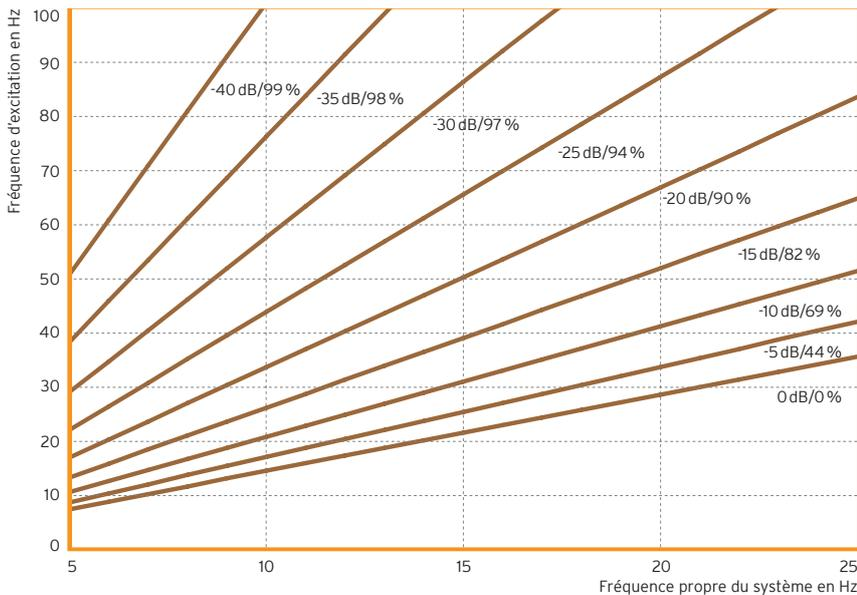
Fig. 4 : Coefficient de transmission et degré d'isolation
